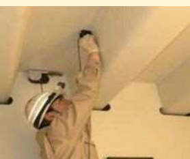
เครื่องตรวจสอบกึ่งอัตโนมัติ ด้วย Ultrasonic (SAUT)
