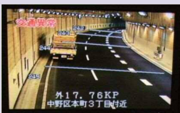
ตัวอย่างการประมวลผลจากภาพ (รถหยุดเคลื่อนที่)
