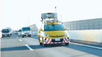
MMS\*計測による定期的な詳細点検
