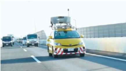
MMS\*計測による定期的な詳細点検
