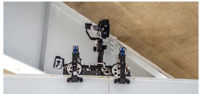
狭隘部でのロボットによる点検
