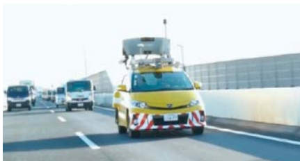
MMS®計測による定期的な詳細点検
