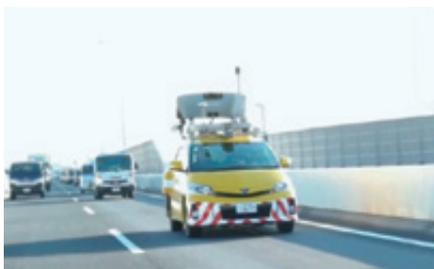
MMS\*計測による定期的な詳細点検
