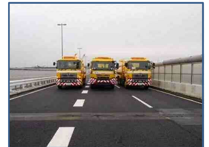
写真-15 22.5t荷重車載荷状況
