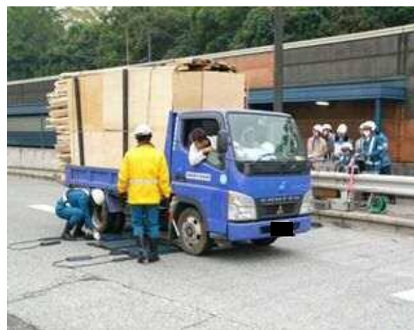
図 2.3.7 車両重量測定状況(大井本線料金所)
