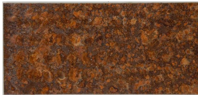
図-6.5-3 腐食促進した試験片の状態
