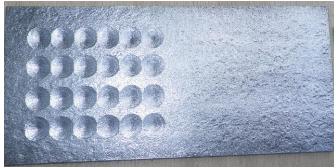
図-6.5-4 素地調整1種相当実施後の状態
