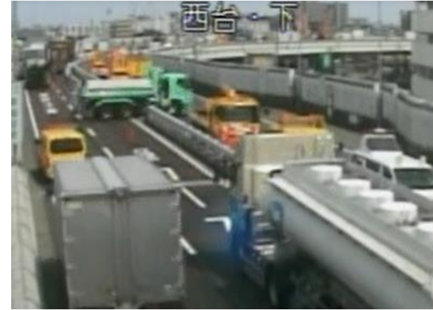
中央分離帯の開口部を用いた滞留車両排出
