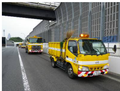
路面清掃（機械清掃）【湾岸線】
