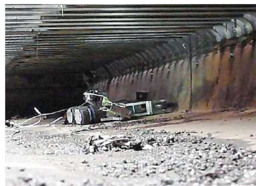
狭隘部用点検ロボットを用いた伸縮継手下面の点検
