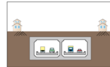
トンネル部 (開削工法区間)
