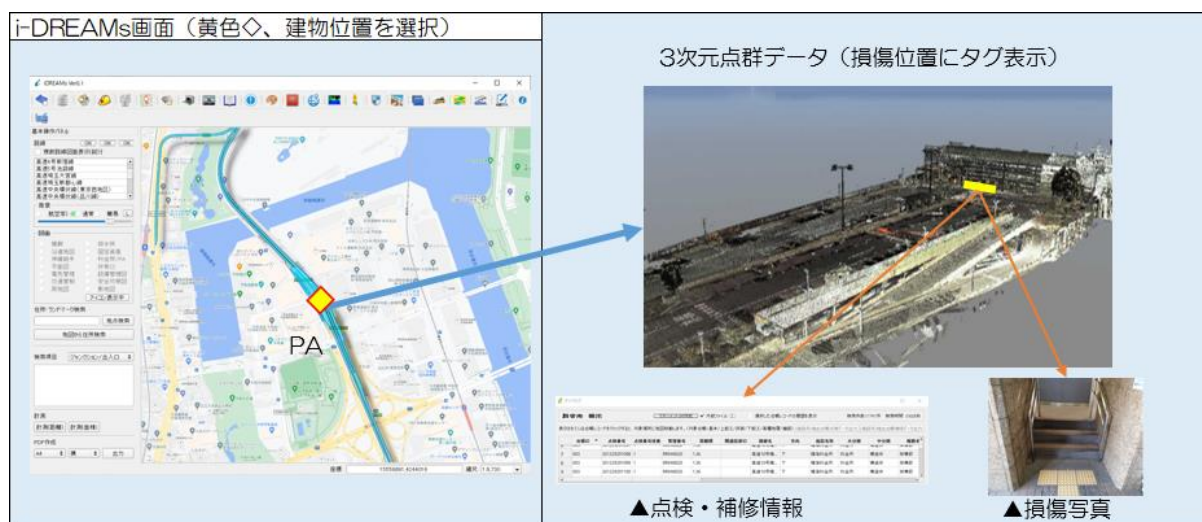
図10. 3次元点群モデルからの属性情報の閲覧イメージ(平和島(上)PA)
