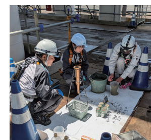
無収縮モルタルの品質確認状況
