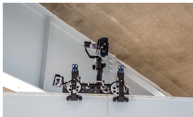
狭隘部でのロボットによる点検
