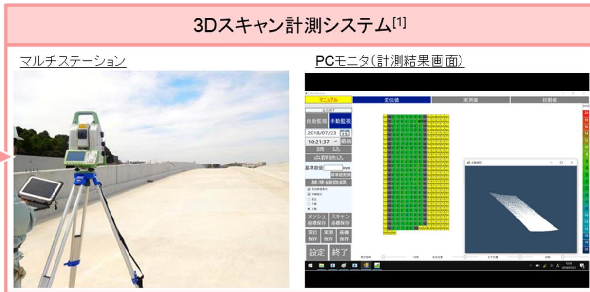
3Dスキャン計測システムの平坦性計測結果(例)
