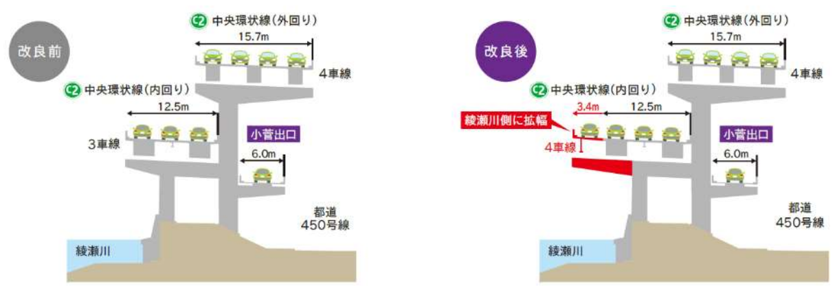
堀切・小菅ジャンクション間4車線化断面図
