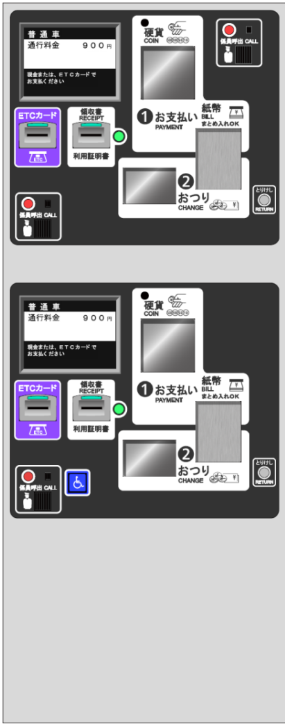
料金精算機(イメージ) H1,900mm × W750mm × D500mm
