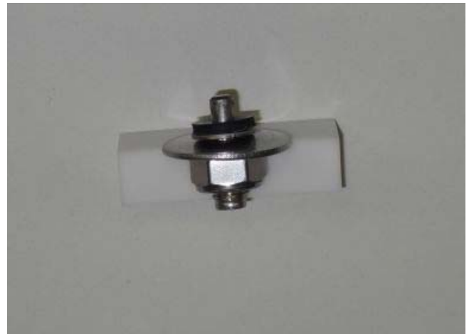
【引き抜けた鋲(打込式ピン)】
