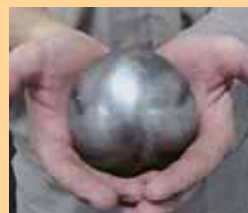
現場の知恵。シールドマシンを回転させた剛球。
