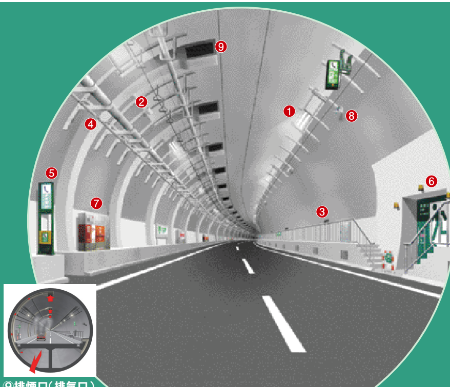
⑨排煙口(排気口)
