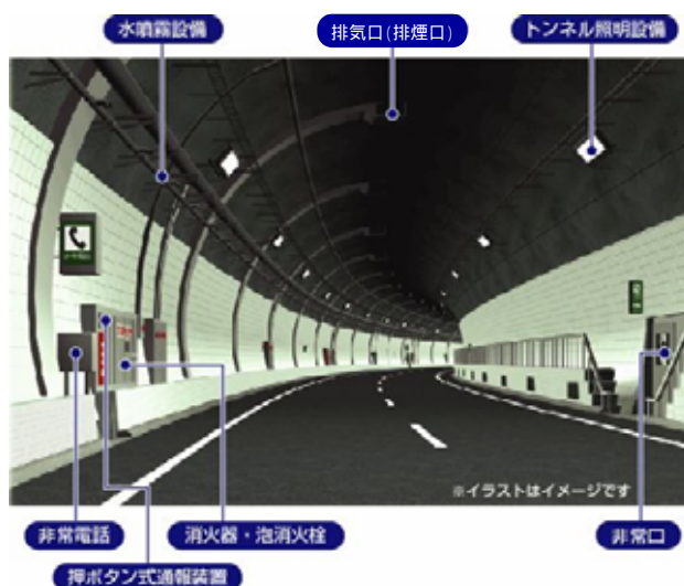
AA等級のトンネル防災設備
