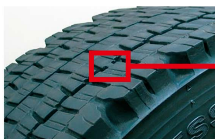
プラットホームとは新品時の溝深さから50%の位置にあるゴムの盛り上がりを設置した部分。
