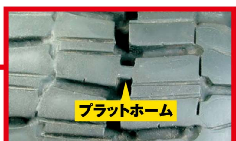
残り溝深さが「プラットホーム」に達していると冬用タイヤとして使用できません。
