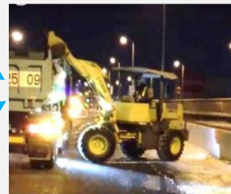
排雪のためショベルからダンプへの積込
