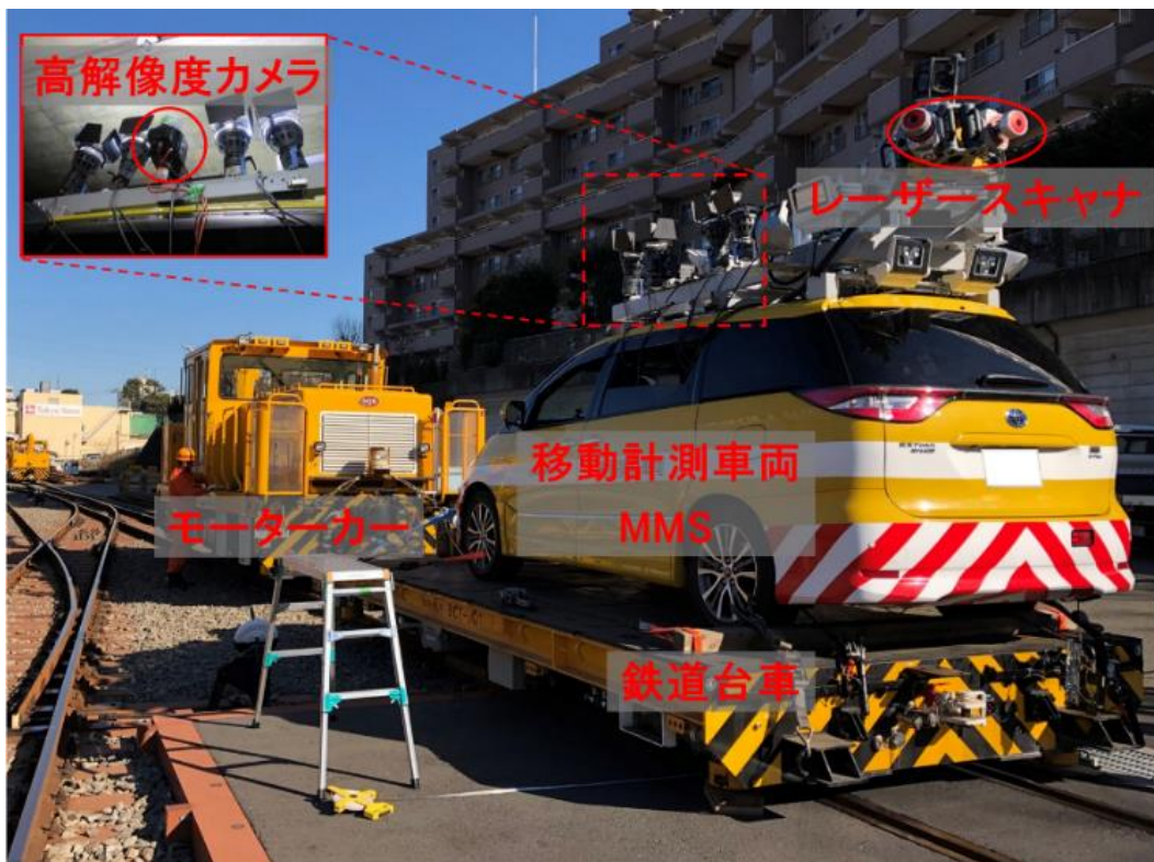
▲鉄道台車に搭載した移動計測車両「MMS」
