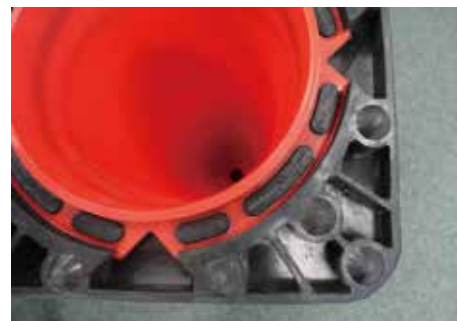
コーンとベースの嵌め込み構造 （コーンの長孔とベースの突起を嵌合）
