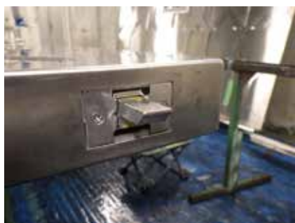
④ロッドガイドよりしみ出しているグリス
