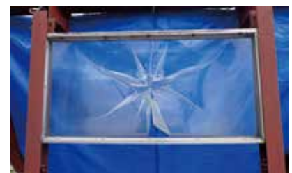
フィルム系飛散対策品 鉄球試験結果（ポリカ板の飛散なし）
