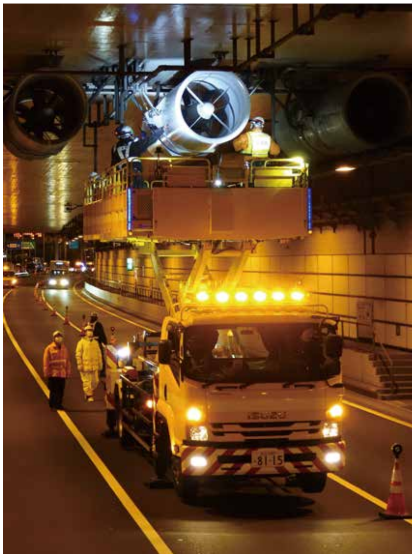
大型作業床が広大な作業空間を確保。また作業床は左右各500mmの拡張も可能
