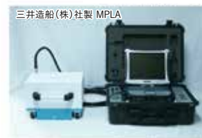
ハンチ形状に合わせて製作した電磁波レーダー装置
