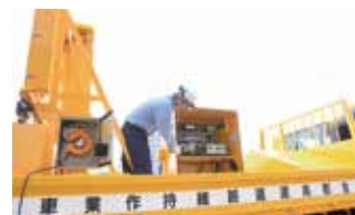
ハイブリッド電源システムの内部と充電様子
