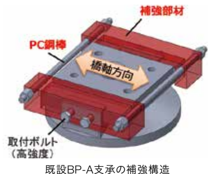
既設BP-A支承の補強構造
