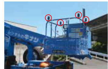
接触防止センサー設置状況
