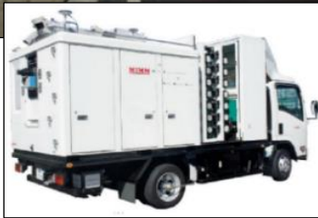
走行型トンネル点検車：レーザー測量器等を搭載
