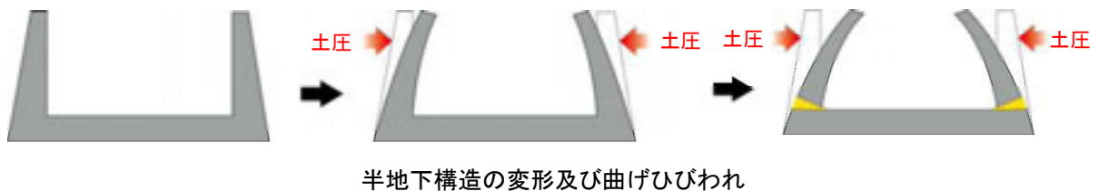
図 3.3.7 構造的に問題となる一般的な半地下部損傷の事例
