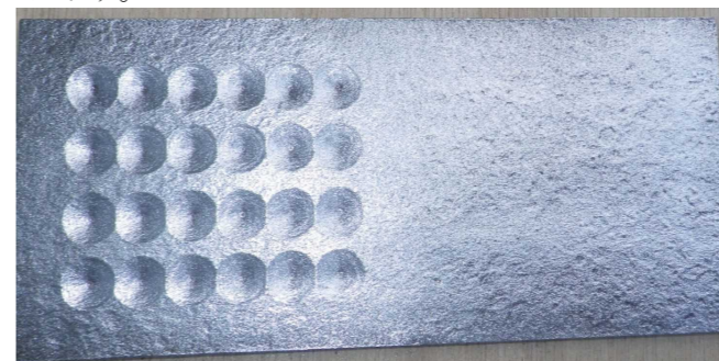
図-6.5-4 素地調整 1種相当実施後の状態
