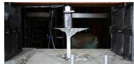
写真 8.17.4-1 あと施工アンカーの引張試験後の状況 (左：既設のアンカーボルト 右：新設のアンカーボルト)
