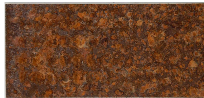
図-6.5-3 腐食促進した試験片の状態
