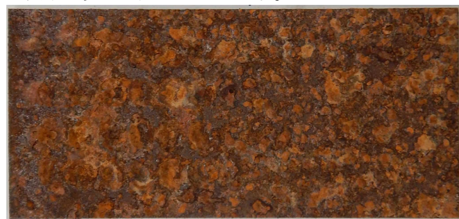
図 6.4-3 腐食促進した試験片の状態
