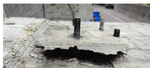
写真 8.17.4-1 あと施工アンカーの引張試験後の状況 (左：既設のアンカーボルト 右：新設のアンカーボルト)
