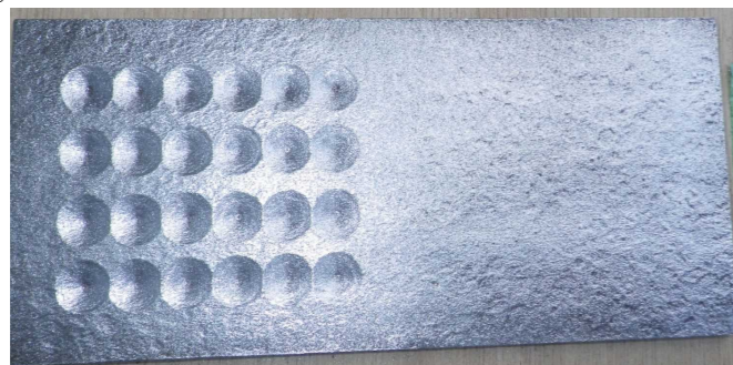
図 6.4-4 素地調整 1種相当実施後の状態
