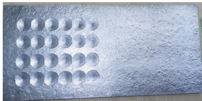
図-6.5-4 素地調整1種相当実施後の状態
