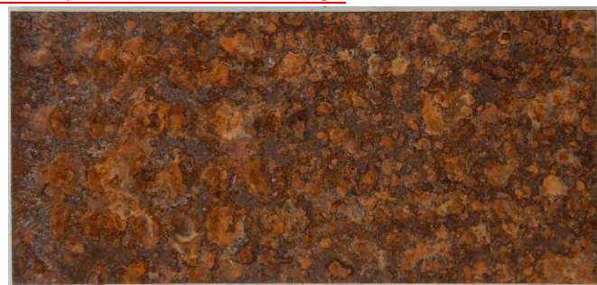
図-6.5-3 腐食促進した試験片の状態
