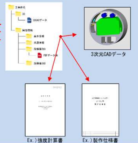
図 10. 3次元モデルからの属性情報の閲覧イメージ(道路附属電気通信設備)
