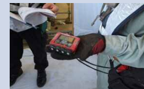
可燃性ガス検知器を常時配備
