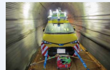
3次元点群データ計測車両(伊豆急行トンネル内)
