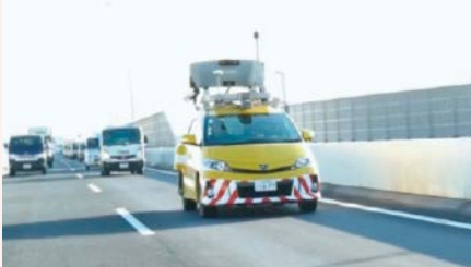
MMS*計測による定期的な詳細点検
