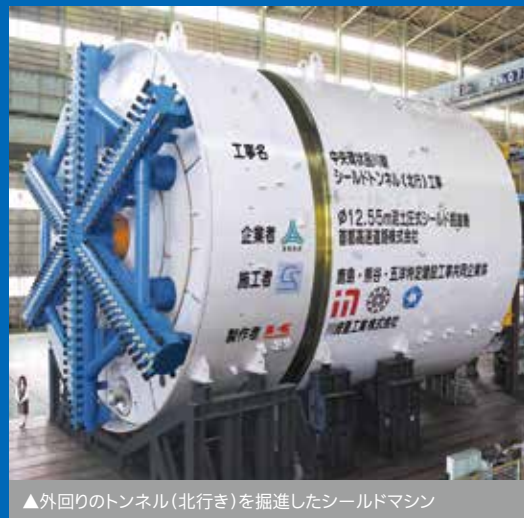
▲外回りのトンネル(北行き)を掘進したシールドマシン
